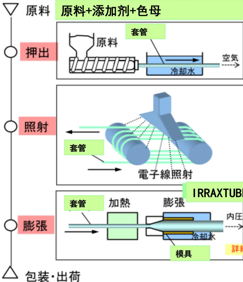
原料挤出, 套管成形。
