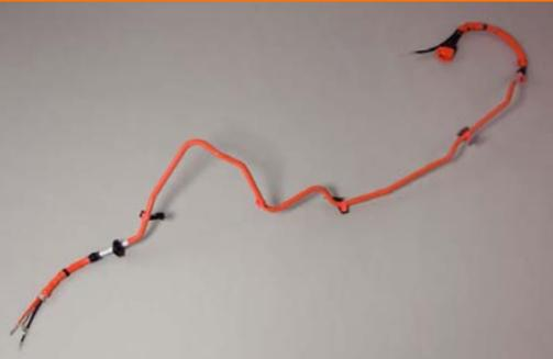
用于混合动力汽车的地板下管套线束
