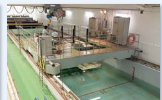
通过实验水槽掌握船舶相关的流体现象
